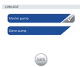
Rys. 19: W tym menu określa się, czy pompa będzie nadrzędna (Master) czy (Slave). Tylko jedna pompa może być ustawiona jako MASTER. Ustawienie więcej niż jednej pompy w trybie MASTER będzie skutkowało chaotyczną pracą.
