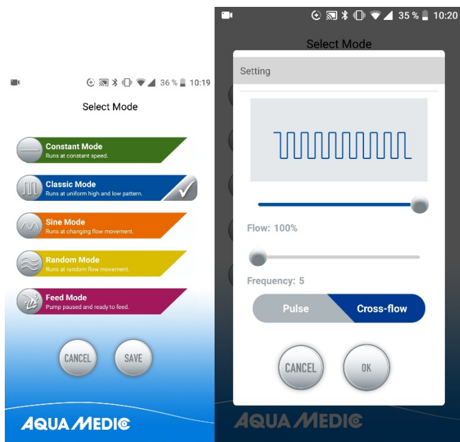
Rys. 25: następnie wciśnij symbol fali w „Classic Mode” i wybierz „cross-flow” – wtedy pole podświetli się na niebiesko. Wydajność pompy ustawia się w polu „flow” a częstotliwość w „frequency”. Minimalna wartość to 30 sekund, max to 90 miunut. Aby zapisać wciśnij OK i SAVE. Zazwyczaj potrzeba około 2-3 cykli, aby pompy zaczęły właściwie pracować w zadanym rytmie. Dlatego należy zacząć od nastawy niższej wydajności i po ustaleniu rytmu zwiększać moc.
